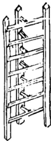
植三角式用三木作柱高八尺中設檔九層相懸各八寸前檔長六尺後檔長三尺前檔木之中俱平鑲一短準各長四寸後檔木之頭各裁成準口湊於前檔木之短準上中穿一孔用竹釘綰住可使轉移摺疊○小蠶用小植高四尺餘濶亦四尺檔用五六層可置牀帷之內
